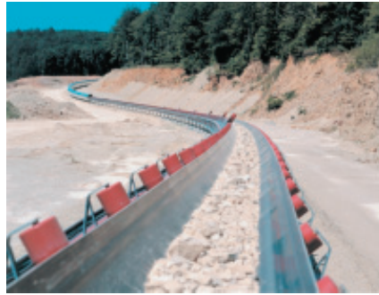
Gurtförderer für den Schüttguttransport. Quelle: ContiTech Transportbandsysteme GmbH
